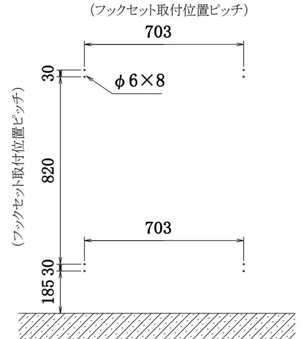
\* 震度7(818gal)程度の強い地震でもガスボンベを転倒させない為に
