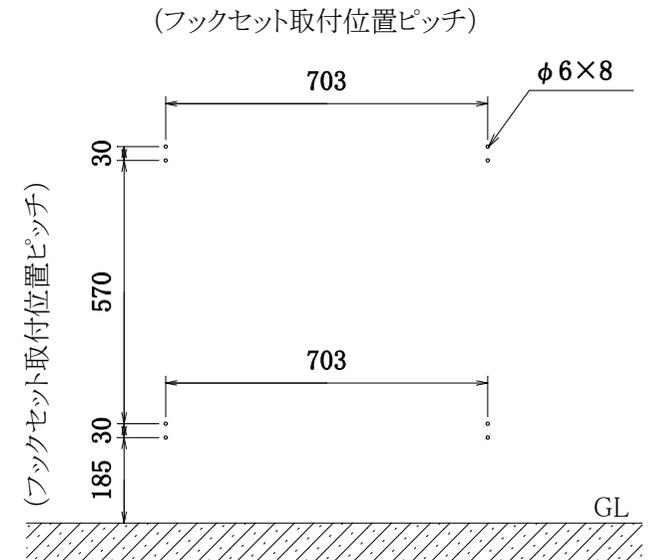
※ 震度7(818gal程度)の強い地震でもガスポンペを転倒させない為に
