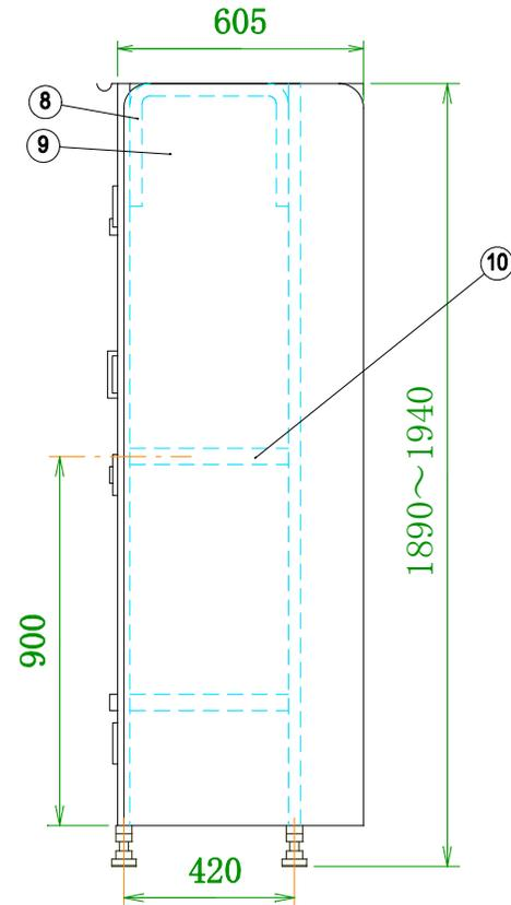
\*震度7(818gal)程度の強い地震でもガスボンベを、転倒させない為に必ずボンベチェーンは上下2本懸けとして下さい。
