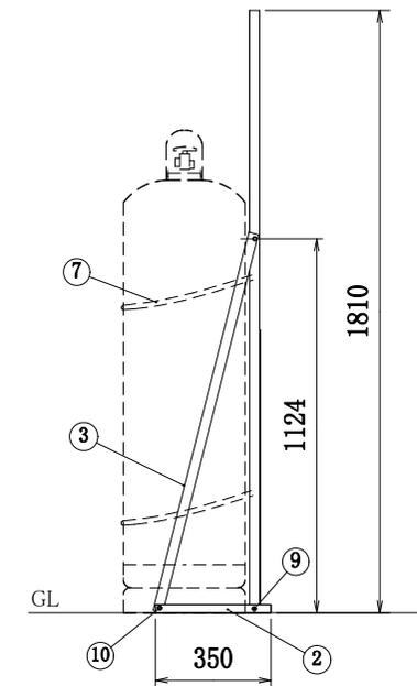
\* 震度7 (818gal程度) の強い地震でもガスボンベを転倒させない為に必ずボンベチェーンは上下2本懸けとして下さい。
