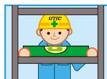
組立完了後、水準器を上下全体の棧に乗せて水平を確認してください。
